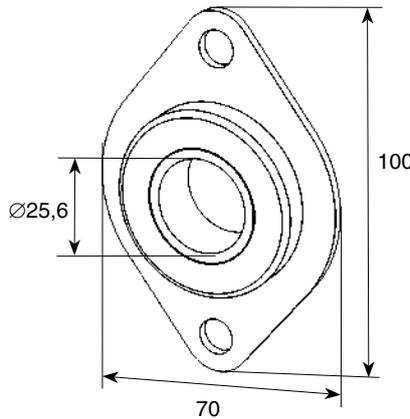
**END PLATE WITH BEARING 1" / ПЛАСТИНА КОНЦЕВАЯ С ПОДШИПНИКОМ 1"**
