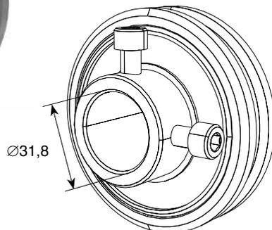
**ASSEMBLED 1,25" SHAFT BUSHING / ВТУЛКА ДЛЯ ВАЛА 1,25" В СБОРЕ**
