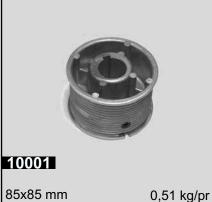
RU Барабан для стандартного подъема М076-2840 Макс. высота ворот = 3000 мм; Макс. вес ворот = 320 кг; Диаметр вала = 25,4 мм; Макс. диаметр троса = 4 мм; Размер бокового кронштейна = 67 мм.
